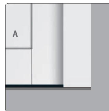
Rahmen-Flügel-Konstruktion mit Einsatzfüllung
